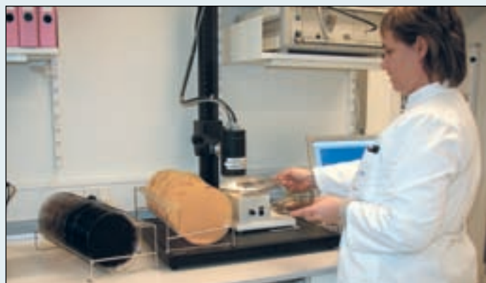
Figur 4. Betina Heide, Novozymes, i færd med at måle iodfarvede, stivelsesholdige besmudsninger på glasplader (til venstre) og ægbesmudsede glasplader (til højre) på et ZEISS-reflektansmåleapparat.
