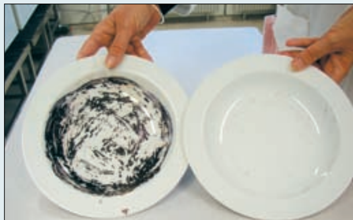
Figur 3. Havregrødsbesmudsede tallerkner vasket uden og med en amylase og derpå iodfarvet. Testbesmudsninger indrettes som regel sådan, at standardbehandlinger ikke efterlader dem helt rene, så der stadig er mulighed for at detektere forbedringer.
