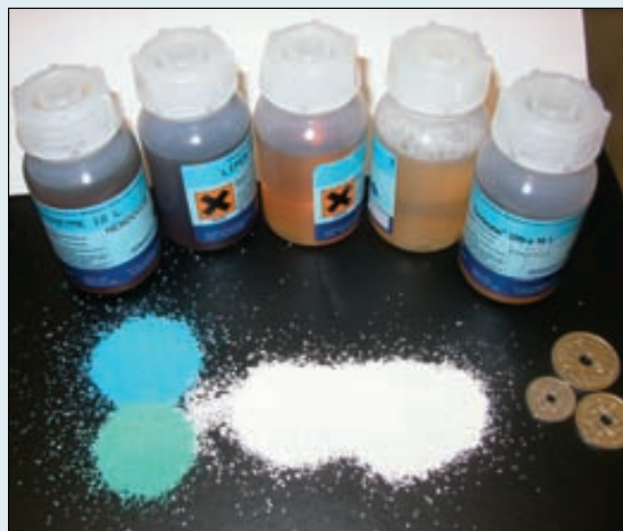
Figur 5. Prøver af flydende enzymprodukter, som de kan fås fra Erhvervsakademi Roskilde (se boks 1), og granulater. Bemærk, at de flydende produkter har farver, som ikke skyldes enzymindholdet, men diverse komponenter fra gæringsprocessen. To af de tre viste granulater er farvede efter ønske fra kunder. Ofte ønskes dog mest muligt hvide granulater.
