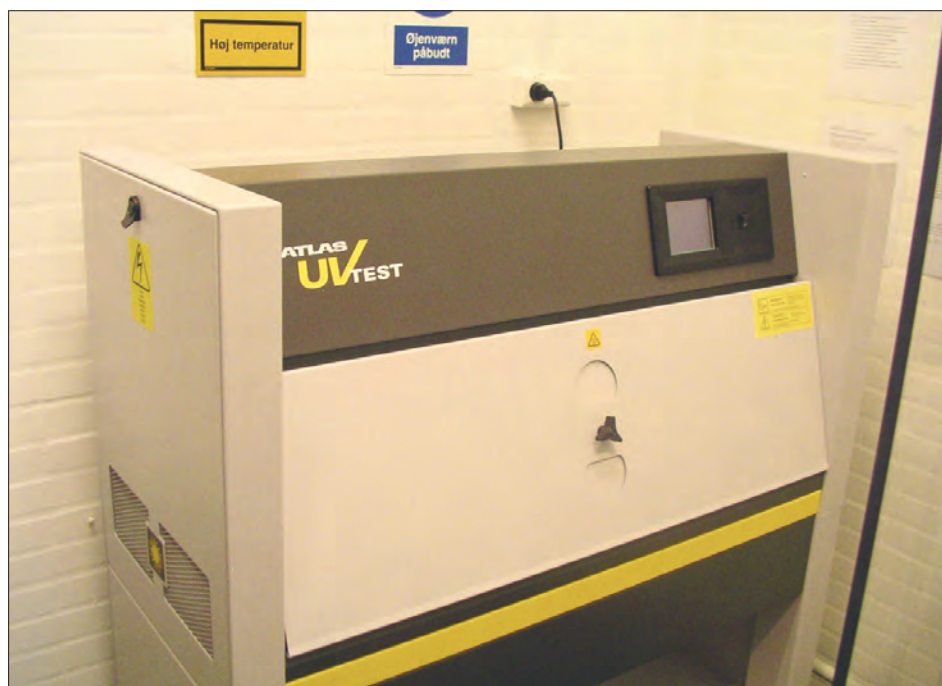
Figur 2. Ultraviolet lyseksponeringsapparat på DTU-Chemical Engineering med mulighed for periodevis kunstig regn. Malingsprøverne er placeret bag den skrå grå plade og en række lysstofrør sørger for belysningen. Apparatet er udviklet af Atlas-koncernen og købt hos danske Strenometer A/S.
