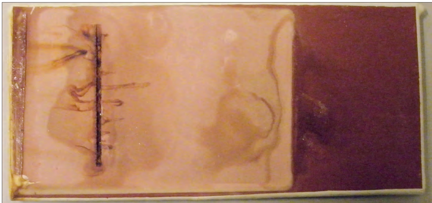
Figur 1. Epoxymaling som har været eksponeret for ultraviolet (UV) lys og fugt. Den røde del af malingen i højre side har ikke været eksponeret, den lyse del har været eksponeret for UV-lys. Det dannede lyse lag kaldes "kridtning" og skyldes pigmentstøv ( \text{TiO}_2 ), som sidder tilbage efter at binderen (og måske andre komponenter) er blevet nedbrudt og eroderet væk. Til venstre i billedet ses en kunstig revne som skyldes, at malingspanelet har været brugt i en korrosionstest, hvor UV-lyseksponering blot er en del af forløbet. Foto: Andreas Paulsen, Hempel A/S, venligst udlånt og vist med tilladelse.
