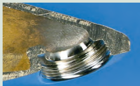
Figur 5. Nikkel udfældet på undersiden af tuden på en vandhane [5].
