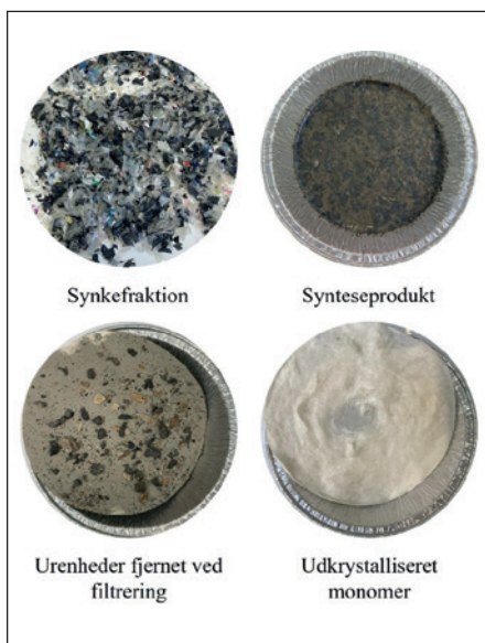
Figur 5. Billeder fra plastaffald til monomeren bis(2-hydroxyethyl) terephthalat (BHET), hvilket inkluderer den ubehandlede synkeaffaldsfraktion, synteseproduktet fra det hydrolyserede materiale, urenheder fjernet fra BHET synteseproduktet ved hjælp af filtrering og det rene udkrystalliserede BHET.
