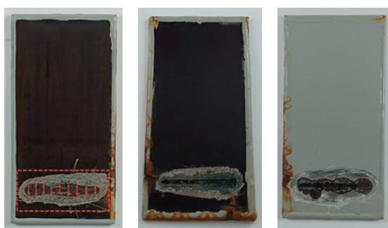
Figur 6. Rustkryb efter 70 dage for sigtet lignin epoxy novolac coating (venstre), sigtet lignin bisphenol F coating (midten) og en kommerciel antikorrosiv coating (højre). Gengivet fra [1].
