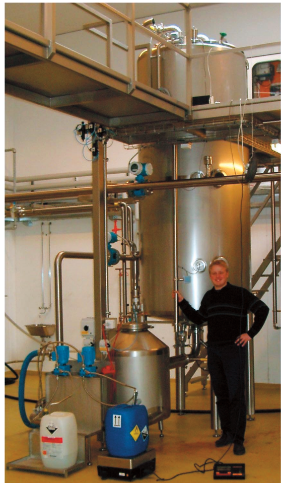
Figur 2. Thomas Grotkjær fremviser forsøgsanlægget, der er etableret i Ishøj. Tankens diameter er 1,256 m. Som standard blev der benyttet et væskevolumen på 3,4 m 3 . Væskevolumenet i recirkulationssløjfen er 70 L, og hele væskevolumenet cirkuleres 2-12 gange i timen gennem recirkulationssløjfen. Der er via de to blå doseringspumper nederst til venstre i billedet mulighed for at sprøjte syre eller base ind i recirkulationssløjfen.
