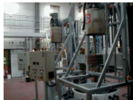
Figur 3. Laboratorierotorer er et vigtigt værktøj i udvikling af antifoulingmaling. Her undersøges især polerings- og biocidudledningsmønstre, men i dette arbejde er opstillingen også brugt til at bestemme friktionsmodstand på en simuleret skibsside.
