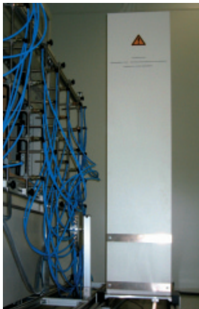
Figur 2. Måleopstilling til test af »personpassage«. Pladen bevæges 6 gange forbi stinkskalet med en hastighed på 1 m/s. (Stinkskaletestrum hos Infralab GmbH, Tyskland).
